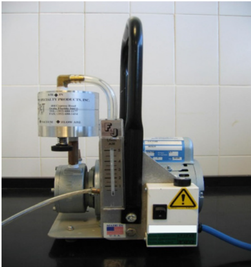
Figura 2: Bomba de muestreo de bajo caudal
