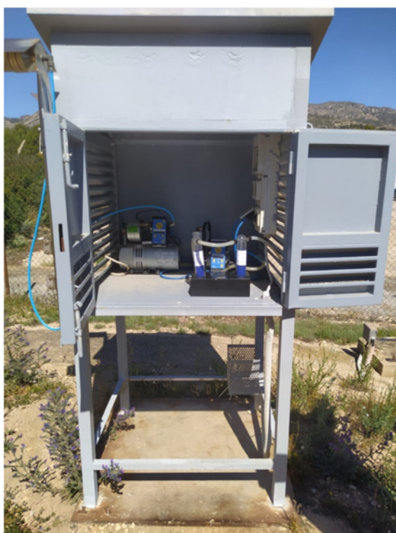
Figura 7. Equipo de toma de muestras montado en campo
