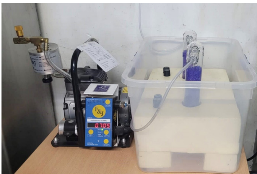
Figuras 5 y 6. Equipos de toma de muestras ya montados
