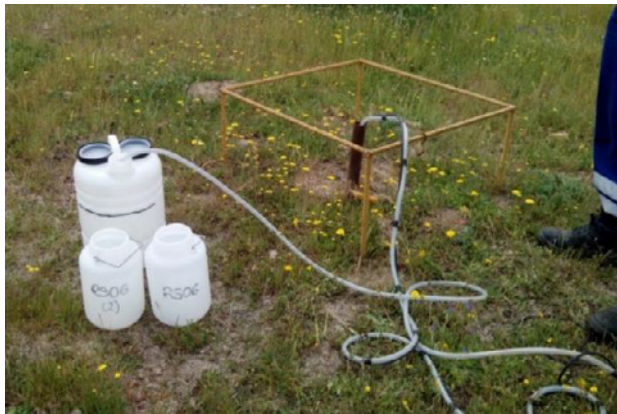
Figura 10. Toma de muestra agua subterránea en sondeo con bomba de bajo caudal y bidón de homogeneización.
