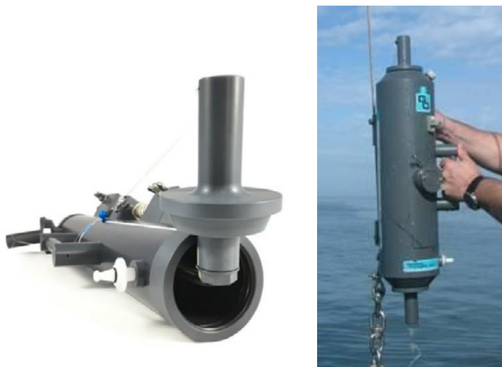
Figura 7. Toma de muestras profundas. Botella Niskin.
