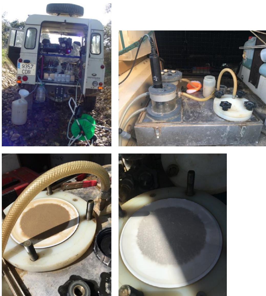
Figura 2. Vehículo tomamuestras provisto de grupo electrógeno y sistema de filtración in situ.
