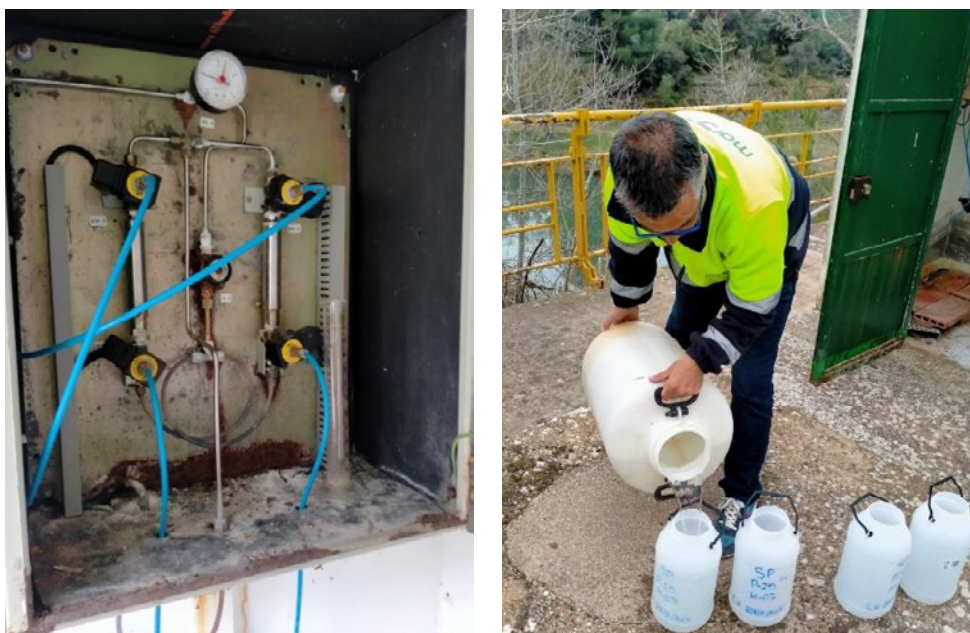
Figura 3. Toma de muestras con separación de alícuotas.
