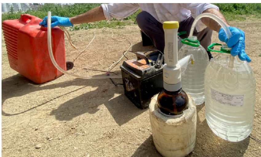
Figura 4. Generación de alícuotas con bidón de homogeneización y acidificación in situ.
