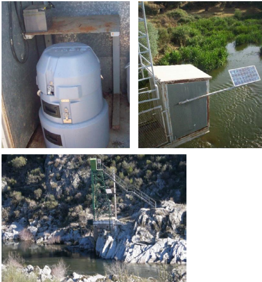
Figura 9. Equipo de toma de muestras en continuo con alimentación solar en aguas superficiales.
