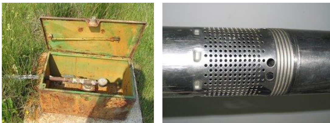
Figura 8. Toma de muestras de aguas subterráneas. Con bomba y cabezal.
