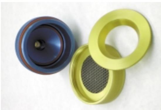
Figura 3. Despiece del captador de un muestreador de bajo flujo
