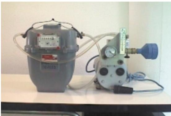
Figura 1. Muestreador de bajo flujo
