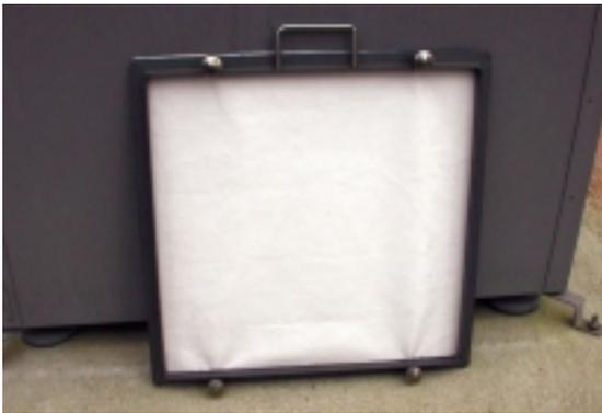
Figura 7. Colector de aerosoles (filtro) con su soporte de un muestreador de alto flujo
