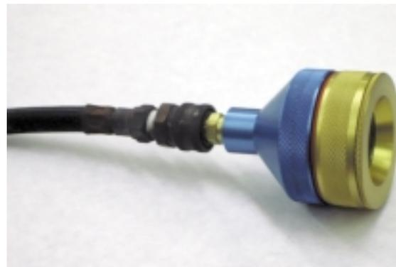
Figura 2. Captador (soporte de colectores) de un muestreador de bajo flujo
