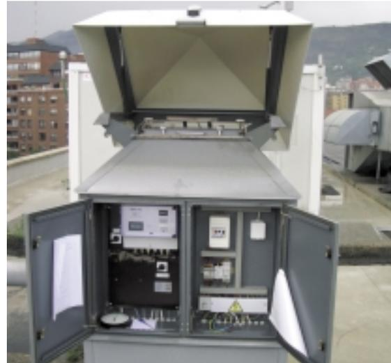
Figura 6. Muestreador de alto flujo, abierto
