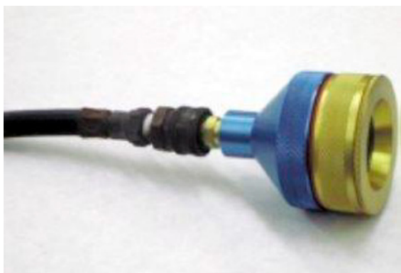
Figura 3: Sistema de captación (donde se ubican los colectores) de un equipo de toma de muestras de bajo flujo.
