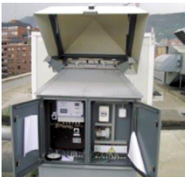
Figura 8: Equipo de toma de muestras de alto flujo, abierto, observando el filtro, y los controladores en la parte inferior.
