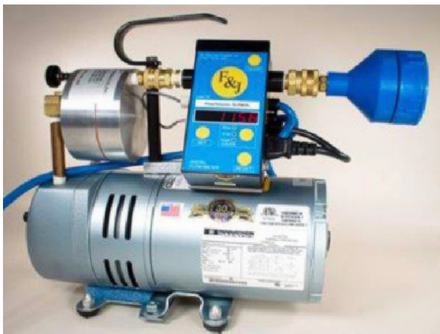
Figura 1: Equipo de toma de muestras de bajo flujo para medidas ambientales.
