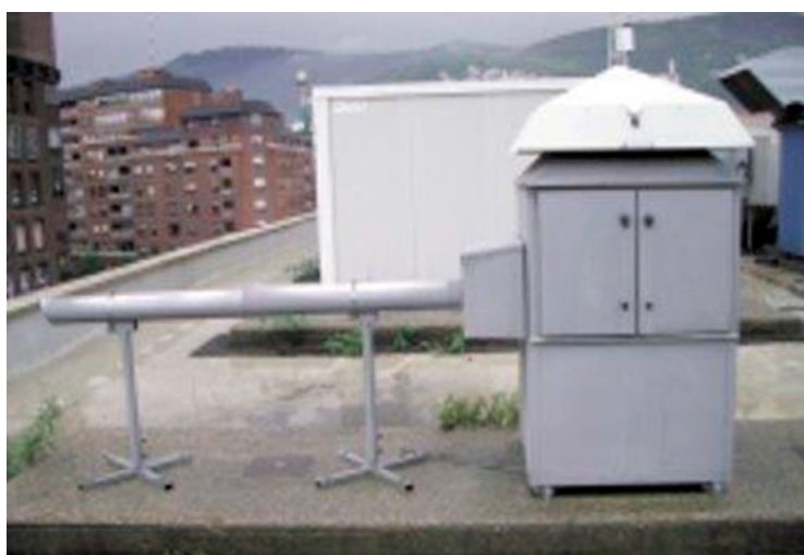
Figura 2: Equipo de toma de muestras de alto flujo para medidas ambientales con captador en plano horizontal. Se observa la salida del aire saliente hacia la izquierda, lejos del aire que se muestrea.
