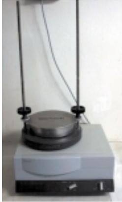
Figura 3. Tamizadora vibratoria para muestras de suelos
