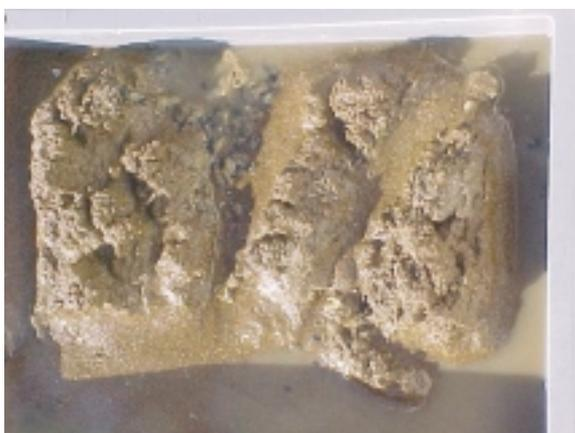
Figura 4. Muestra “perturbada” obtenida con muestreador tipo “cuchara”
