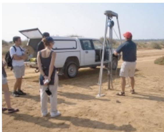
Figura 3. Extracción con muestreador tipo “cilindro”
