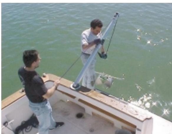
Figura 2. Extracción con muestreador tipo “draga”
