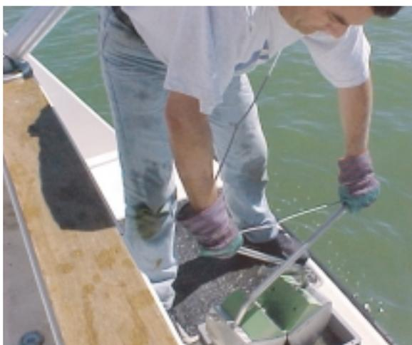
Figura 6. Extracción con muestreador tipo “draga”
