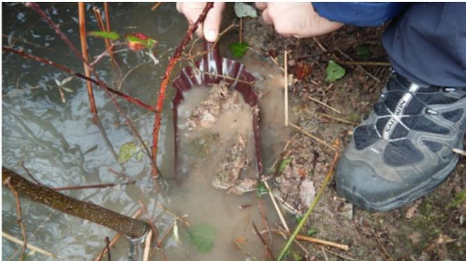
Figura 1: Instrumentos tipo recogedor: draga y pala
