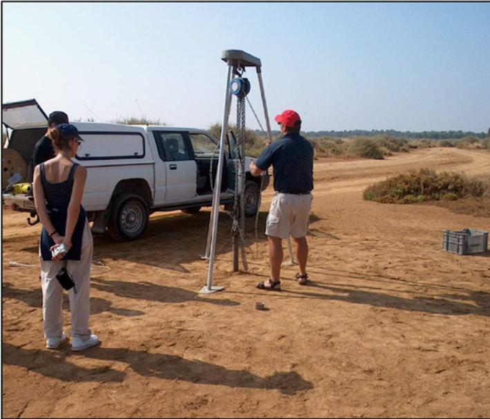
Figura 3: Extracción con muestreador tipo “cilindro”
