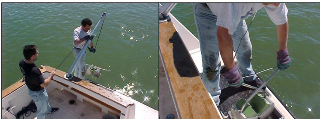
Figura 6: Extracción con muestreador tipo “draga”
