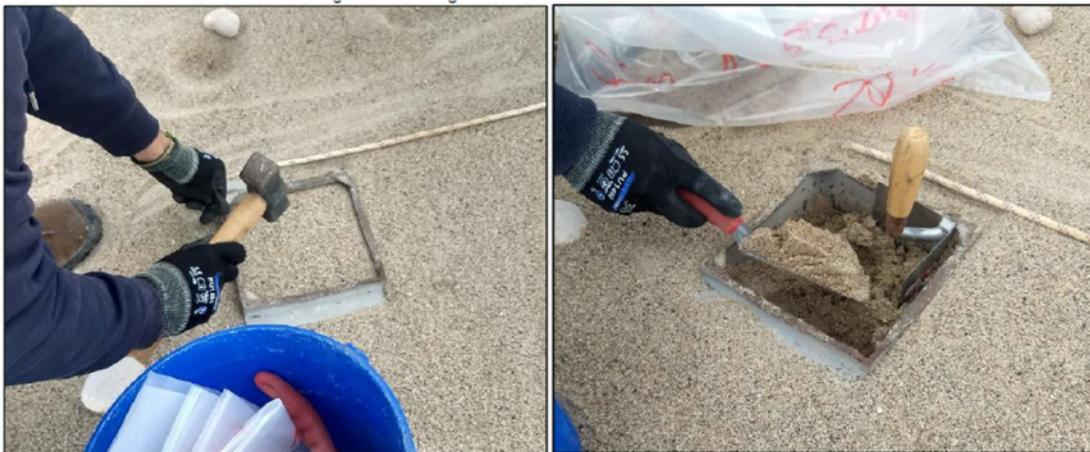
Figura 2: Utilización de plantilla para la extracción de sedimento de orilla (arena de playa).
