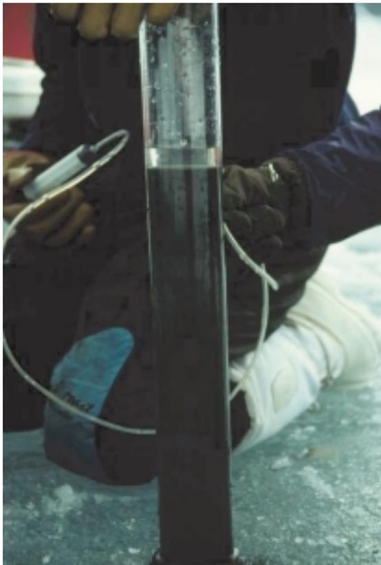
Figura 4. Extracción de un perfil de sedimentos
