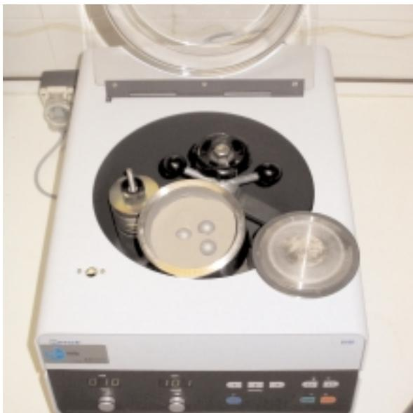
Figura 5. Ejemplo de molino de bolas
