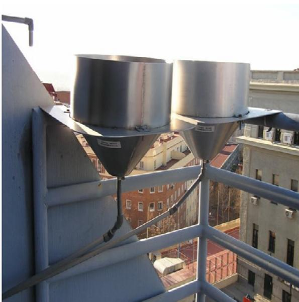
Figura 5. Colectores de superficie con codos en los conductos superiores a  $135^\circ$ .
