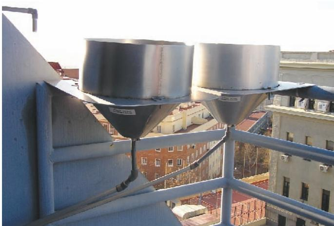
Figura 4. Colectores de superficie en acero inoxidable, con codos en los conductos superiores a  $135^\circ$
