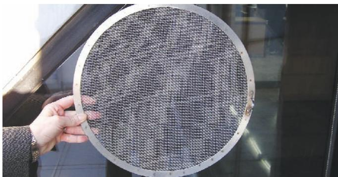
Figura 2. Rejilla de protección para el interior del colector de superficie
