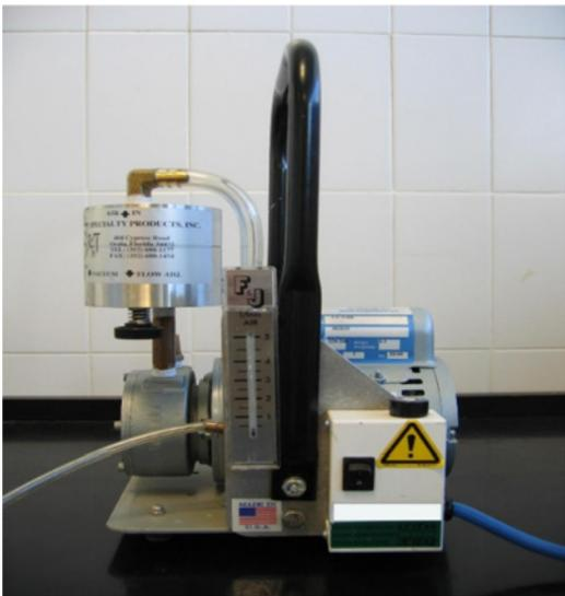
Figura 2: Bomba de muestreo de bajo caudal
