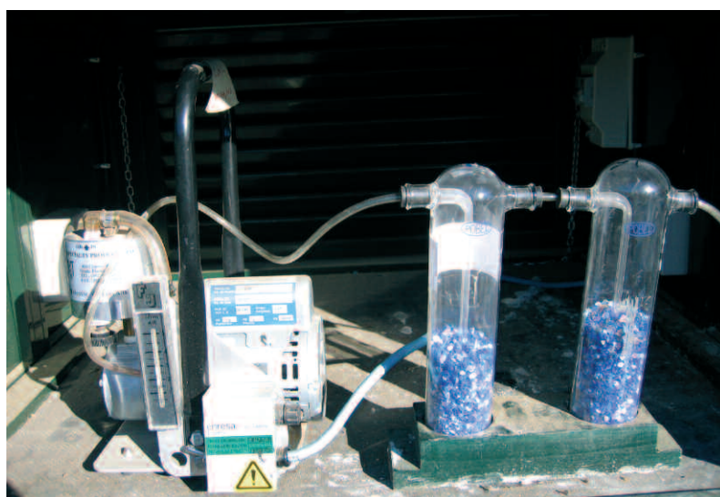
Figura 6. Sistema de muestreo de H-3 montado en campo
