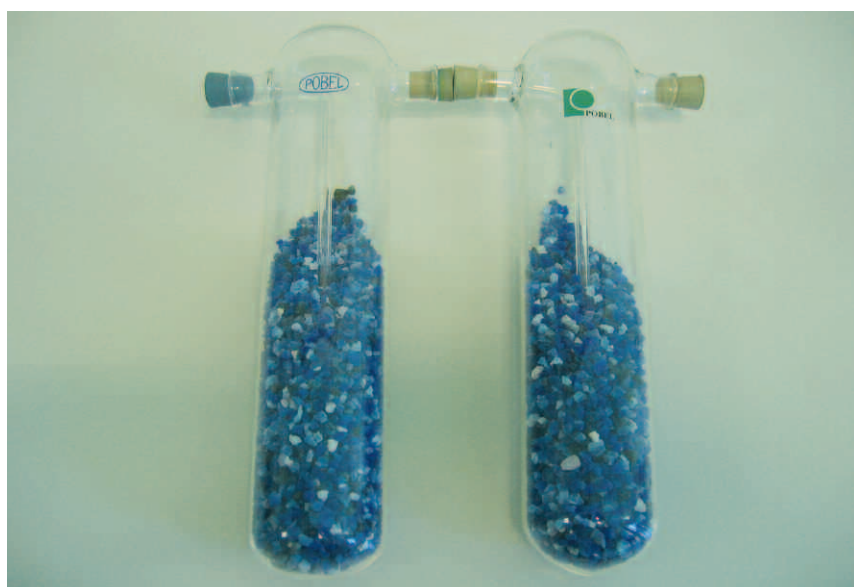
Figura 2. Trampas de vidrio con gel de sílice
