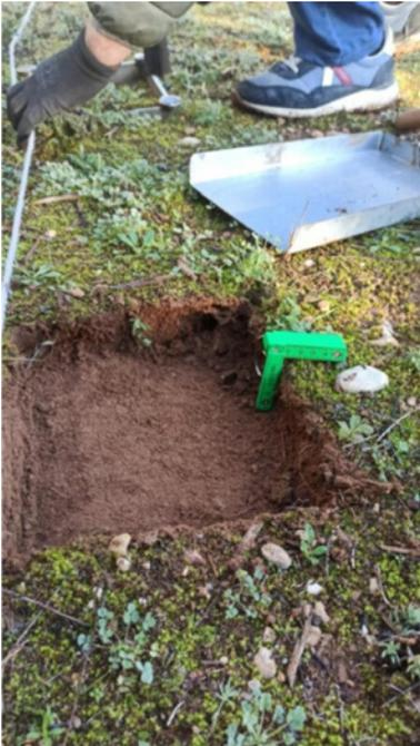
Figura 8: Sistema sencillo de determinación de profundidad
