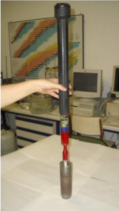
Figura 3. Cilindro de toma de muestras con martillo deslizante
