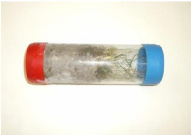
Figura 10: Suelo encapsulado en el *liner*
