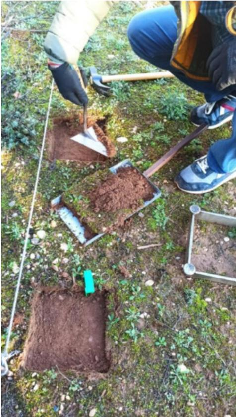
Figura 9: Extracción de suelo de la plantilla
