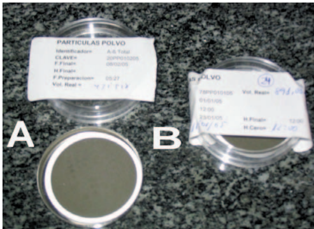
Figura 3. Ejemplos de recipientes de uso común para la determinación de: A) los índices de actividad alfa/beta y B) los emisores gamma presentes en los aerosoles colectados en uno o varios filtros como los utilizados con muestreadores de bajo caudal.
