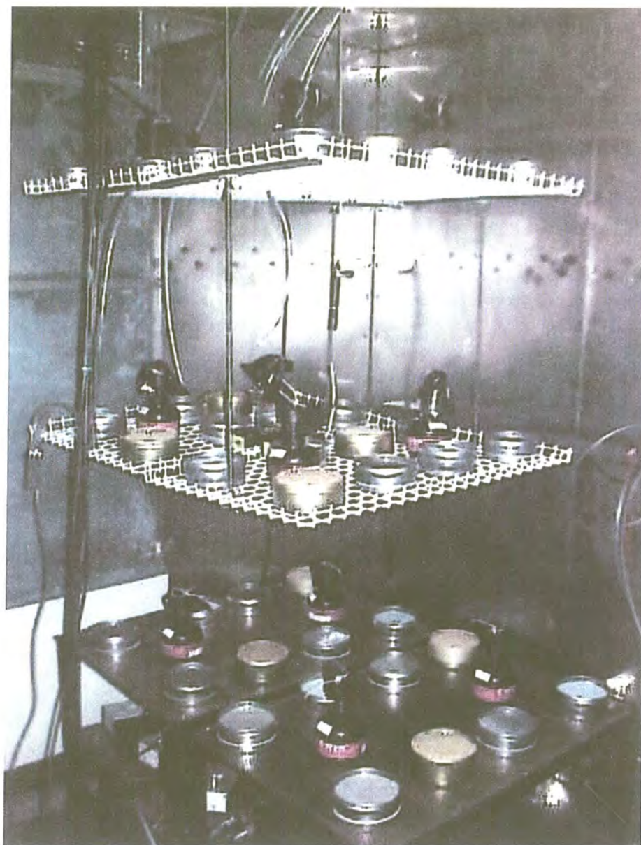
Figura 14. Exposición de cartuchos de carbón y electrets SST en el interior de la cámara de radón
