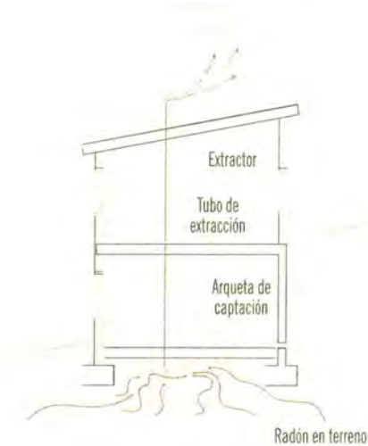
Figura 20. Barrera sobre solera más extracción (2.S.2.2)
