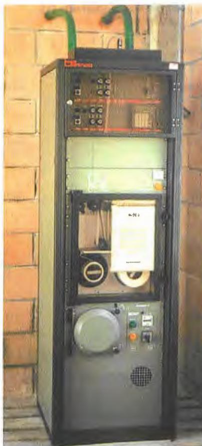
Figura 2. Estación radiológica automática (ERA) de una estación de la REA
