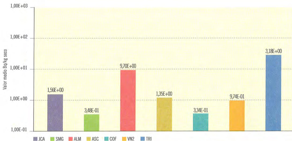
Figura 2.23b. Sedimentos de fondo. Concentración de actividad de Co-60 (Bq/kg seco)
