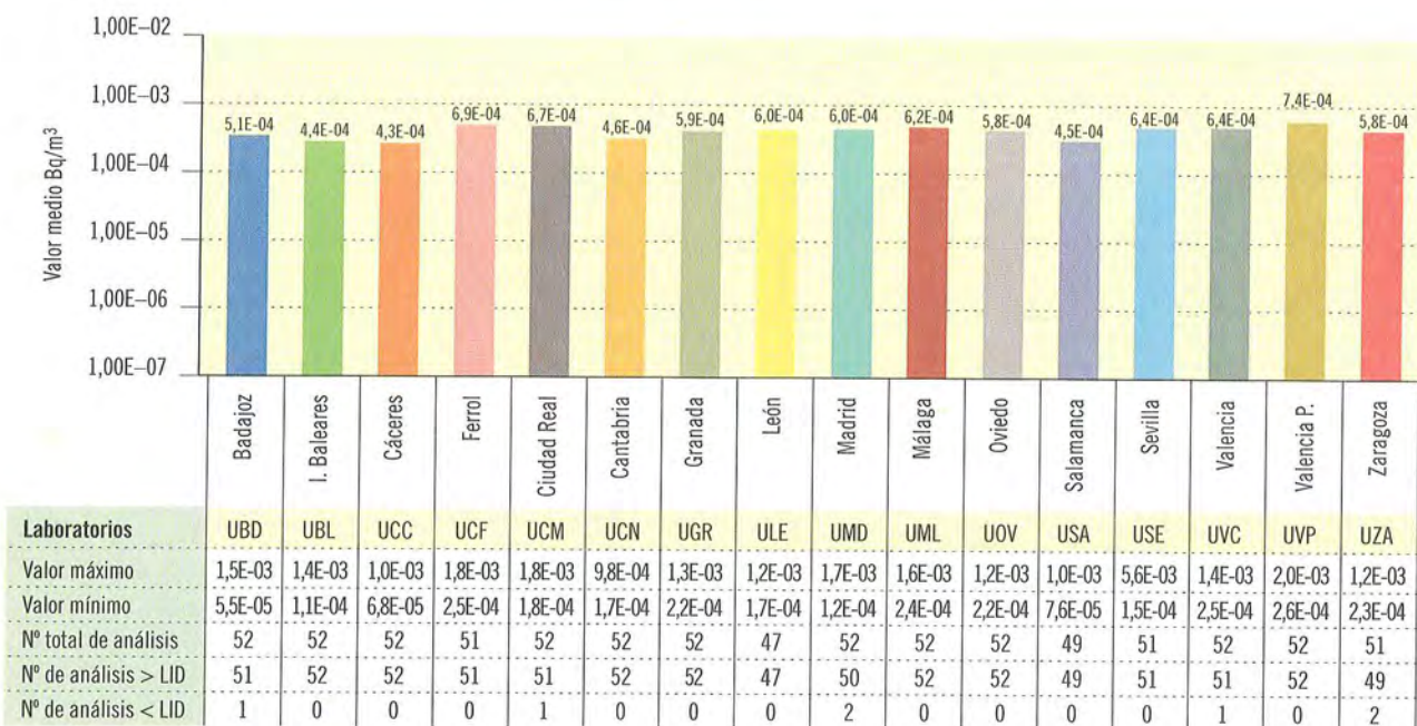
Figura 3.3b. Partículas de polvo en el aire. Concentración del índice de actividad beta total (Bq/m³)
