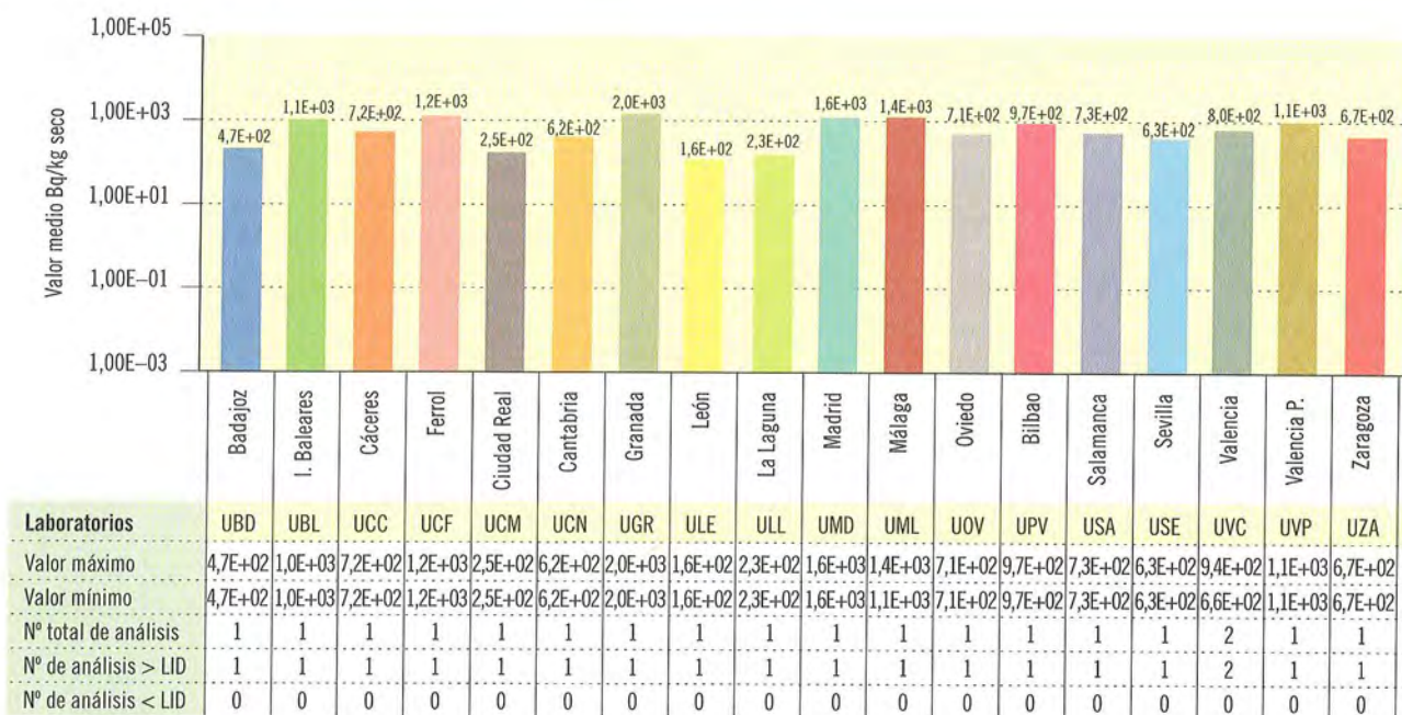
Figura 3.7b. Suelo. Concentración del índice de actividad beta total (Bq/kg seco)
