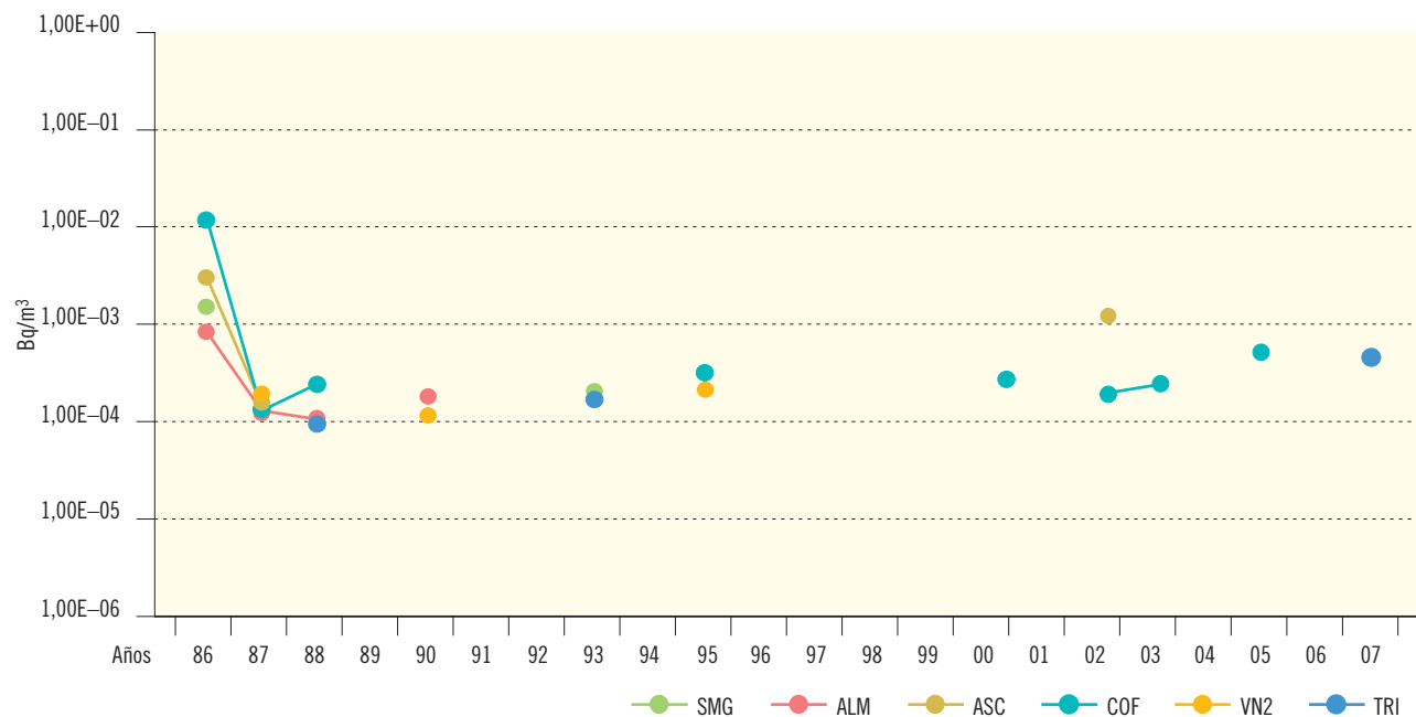
Figura 2.9b. Radioyodos en aire. Concentración de actividad I-131 (Bq/m³)
