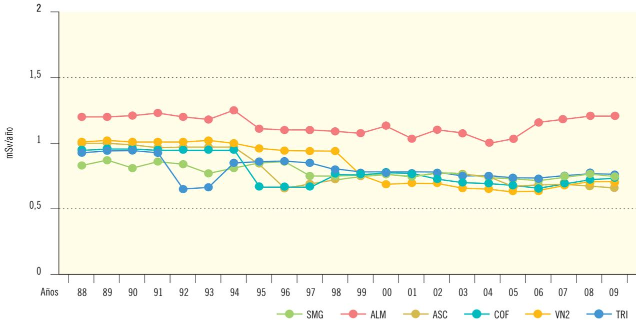
Figura 2.9b. Radiación directa. Dosis integrada (DTL) (mSv/año)
