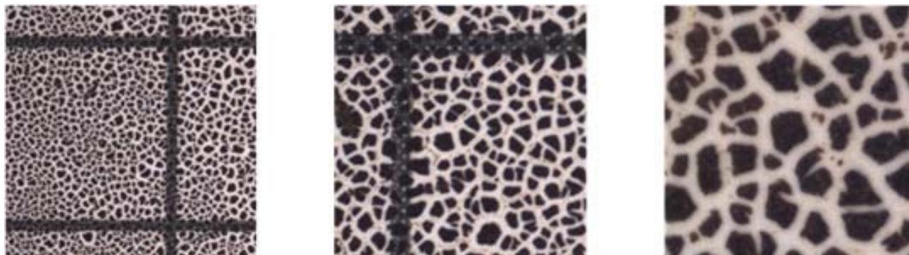
Figura 5.6. Visualización de los diferentes componentes del precipitado a través de una imagen de la sección transversal del filtro.
