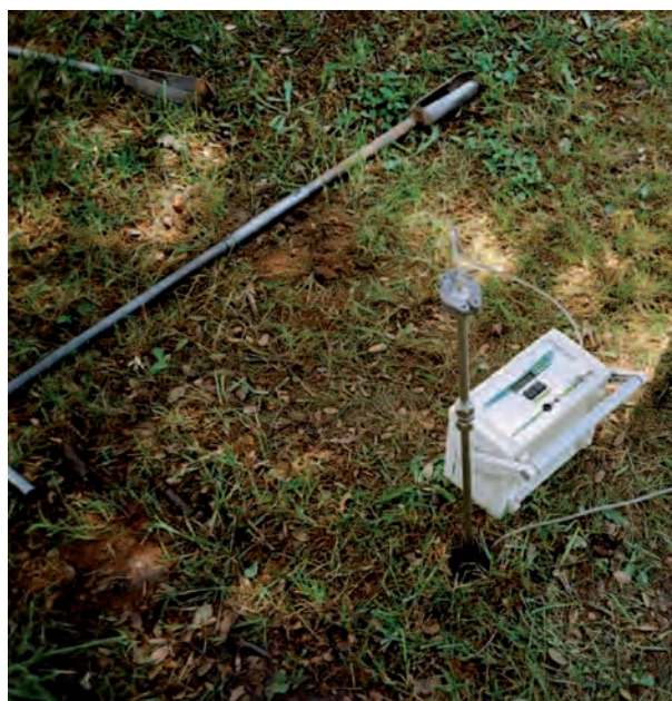
Figura 4.1. Instrumentación para medir la concentración de 222 Rn en la fase gaseosa del suelo
