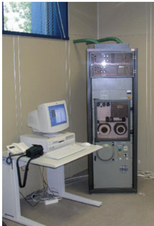
El DSIC tiene como función transmitir los parámetros de control del sistema, almacenar y preparar la información obtenida por la ERA y la EMA para su transmisión al CSC de la REA a través de la red telefónica conmutada o telefonía GSM. Está compuesto por una CPU, una placa de comunicaciones con módem incorporado, una fuente de alimentación y baterías.
