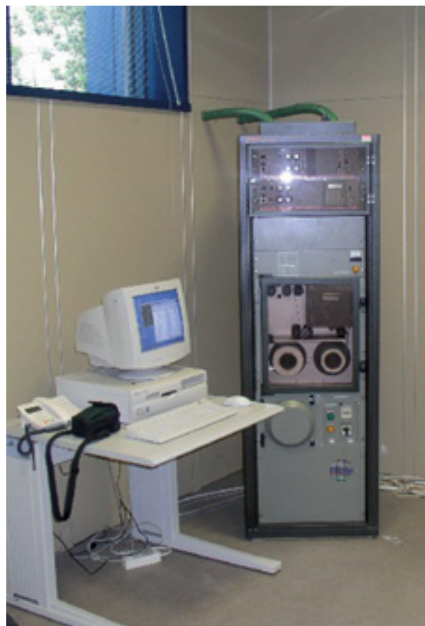
Figura 1.1. Estación radiológica automática (ERA) de una estación de la REA
