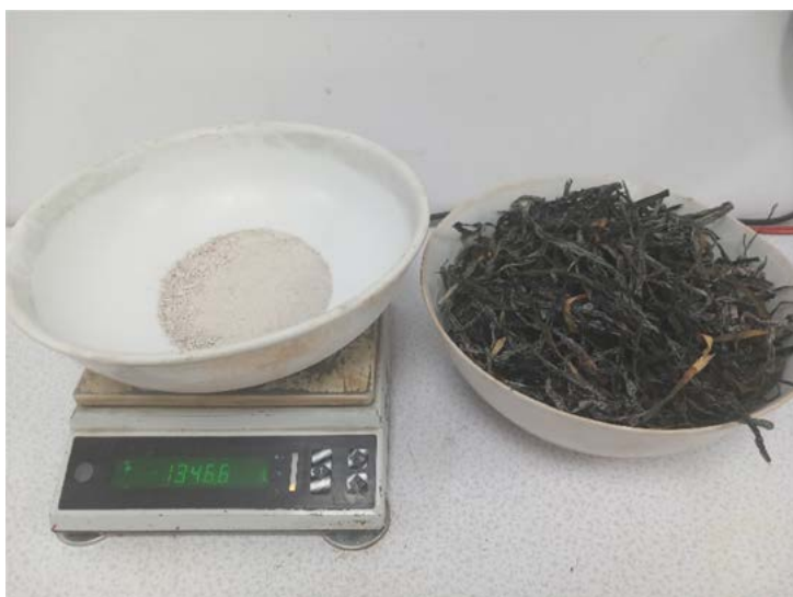
Figura 11. Muestra de posidonia, desecada (derecha) y calcinada (izquierda). Nótese la coloración homogénea y blanquecina de la muestra, denotando la total eliminación de materia carbonosa.
