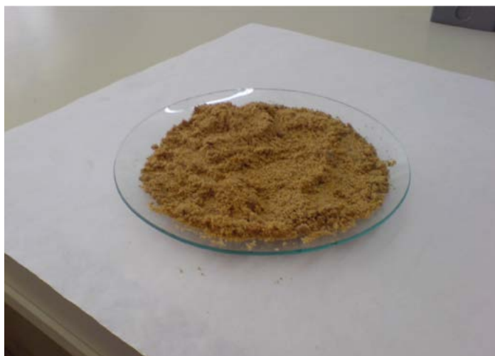
Figura 5. Papilla obtenida tras la desecación de una muestra de dieta, su triturado y homogeneizado
