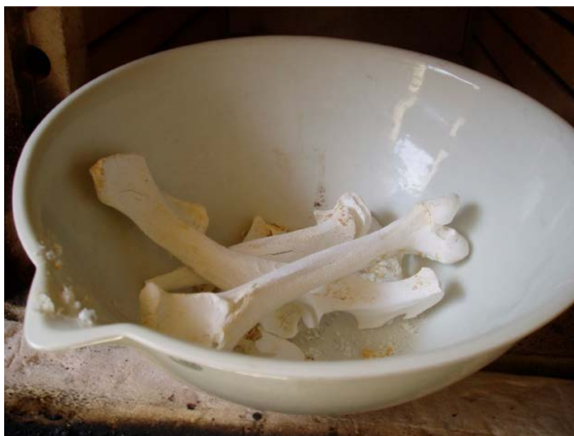
Figura 10. Muestra de huesos calcinados a alta temperatura. Nótese la coloración homogénea y blanquecina de la muestra, denotando la total eliminación de materia carbonosa.
