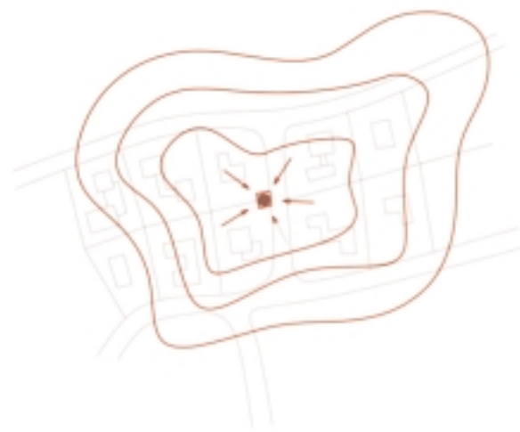
Figura 2.27. Un ejemplo de cómo un punto de captación puede dar servicio a varias viviendas cubriendo una gran superficie de succión. Estos cálculos pueden realizarse con programas de análisis de fluidos
