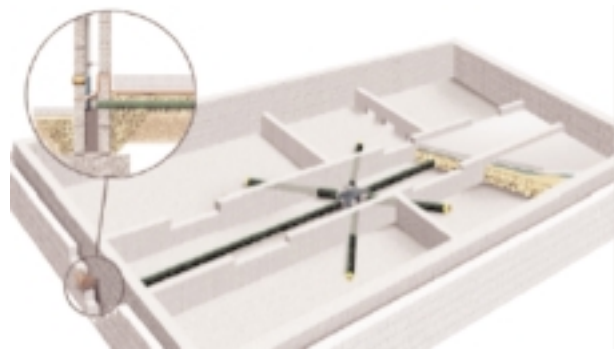
Figura 2.24. Sistema de captación basado en un suelo flotante realizado con paneles de poliestireno expandido con tallas en su base que permiten el paso del aire entre los surcos. Aerobord Ltd. (Askeaton, Co. Limerick)
