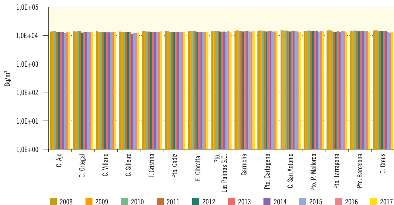
Figura 3.65b. Agua de mar. Concentración del índice de actividad beta total (Bq/m³)
