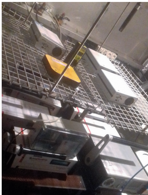
Figura 1. Imagen de los monitores de radón en continuo en la cámara de radón del INTE-UPC durante las fases 1 y 2 del proyecto
