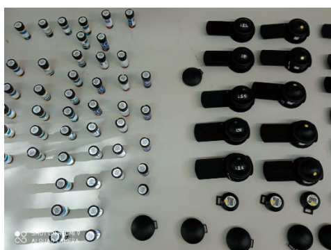
Figura 9. Imagen de los diferentes tipos de detectores que participaron en la intercomparación de sistemas de medidas integradores de la concentración de radón en aire
