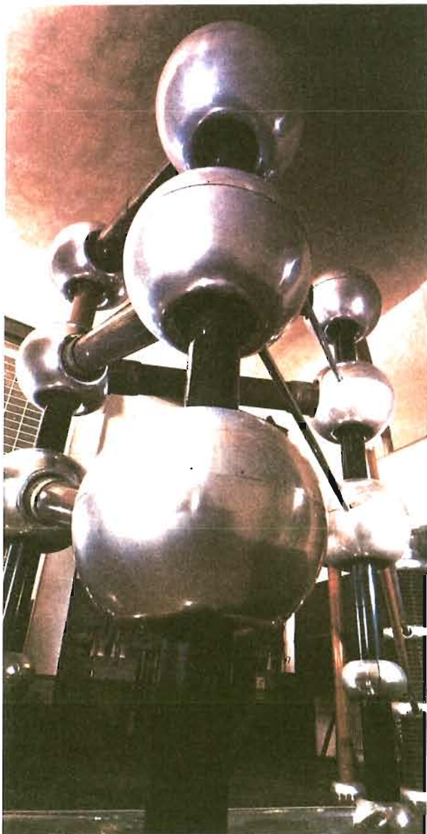
Figura 6: Acelerador Cockcroft-Wallton de 600 KeV de la JEN.
