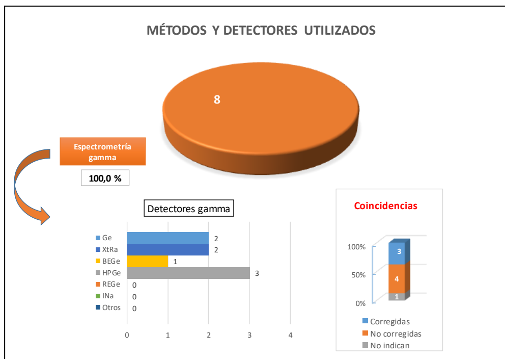
Figura 63. Métodos y detectores utilizados para la determinación del ^{60}\text{Co} en el filtro de 44 \times 44 \text{ cm}^2 de superficie en el plazo de 72 horas.
