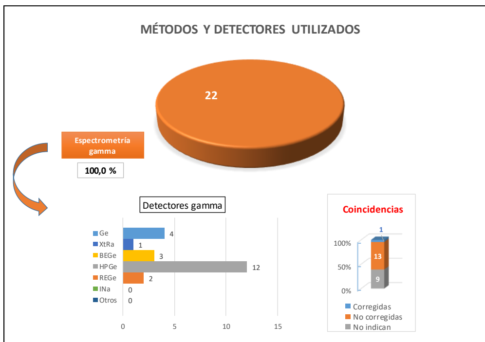
Figura 36. Métodos y detectores utilizados para la determinación del ^{137}\text{Cs} en el filtro de 47 mm de diámetro en el plazo de 72 horas.
