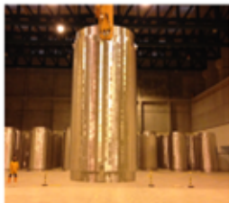
ENSA-DPT Uso: CN Trillo Tipo: Doble propósito Diseñador: ENSA Capacidad: 21 EC
