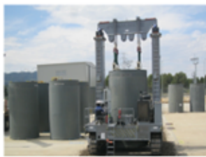
HI-STORM 100Z/100 Uso: CN José Cabrera/CN Ascó Tipo: Modular Diseñador: Holtec International Capacidad: 32 EC
