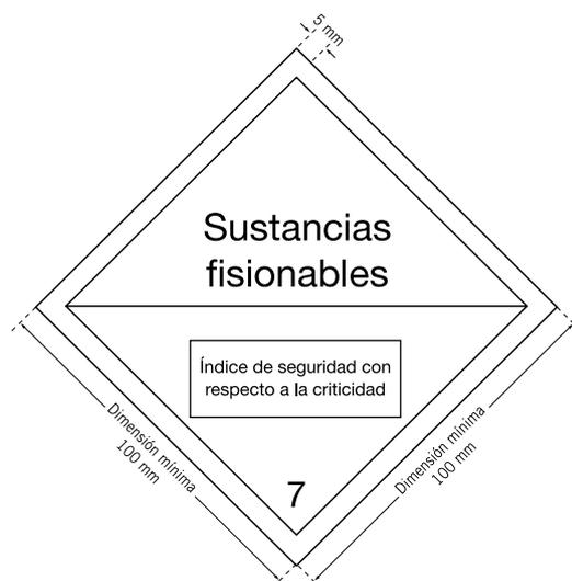
Figura 2. Nueva señalización para bultos con material fisionable
