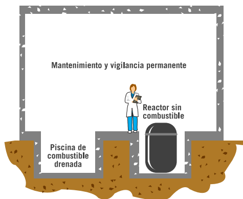
Nivel 1. Instalación en estado casi original
