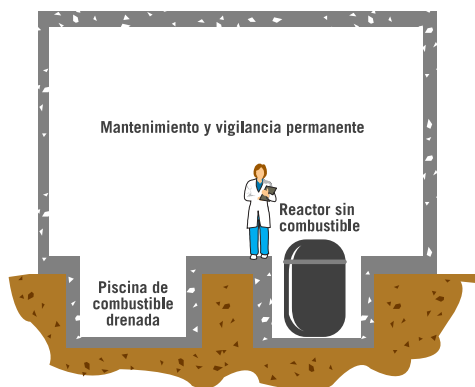
Nivel 1. Instalación en estado casi original
