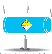
Perforación: caída desde 3 m sobre una barra (peso del bulto \geq 250 kg)
