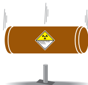
Perforación: caída desde 1 metro sobre una barra
