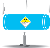
Perforación: caída desde 3 m sobre una barra (peso del bulto \geq 250 kg)
