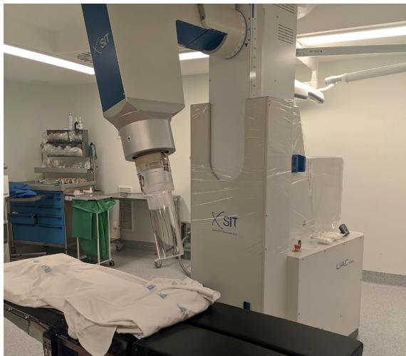
Figura 30. Aplicador para tratamiento de radioterapia intraoperatoria con electrones, producido por un acelerador lineal móvil.
