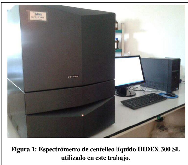
**Figura 1: Espectrómetro de centelleo líquido HIDEX 300 SL utilizado en este trabajo.**
