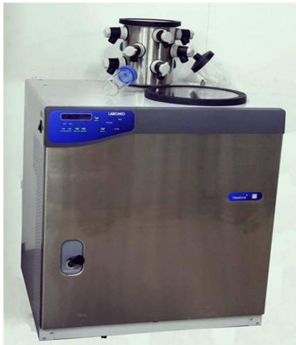
Figura 7.- Liofilizador típico para extraer el agua libre contenida en la muestra como paso previo a la medida de tritio en la misma
