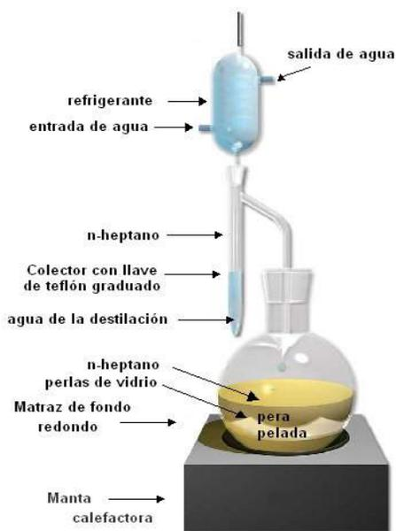
Figura 8.- Equipo de destilación para la extracción del contenido en agua libre presente en un producto de naturaleza orgánica.
