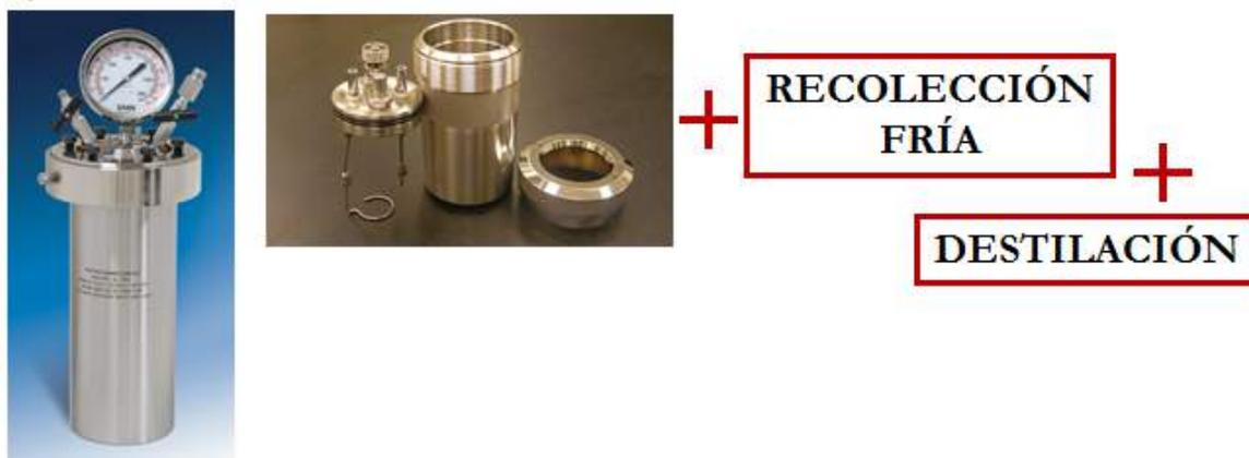
Figura 10.- Bomba calorimétrica de Parr para la obtención de tritio ligado en matrices complejas, orgánicas y/o minerales.
