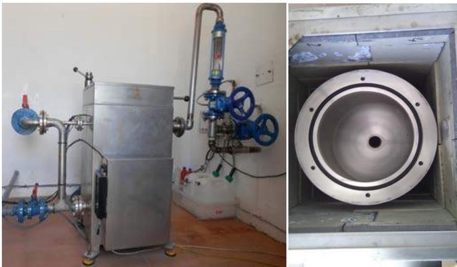
**Figura 3.** Imágenes del monitor de agua de río. Blindaje de la vasija y recipientes de muestreo de agua (izquierda) y interior de la vasija donde se coloca el detector (derecha).
