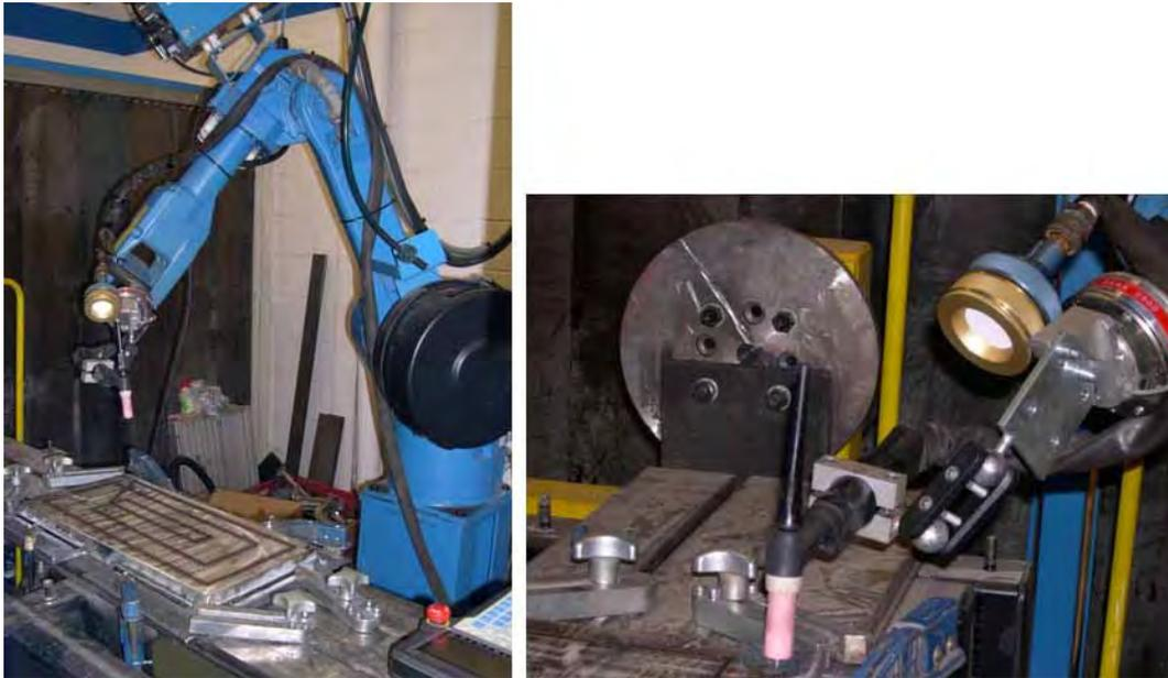
*Fotografía 1: Ensayo de soldadura con el robot automático. Detalle de la colocación del captador*
