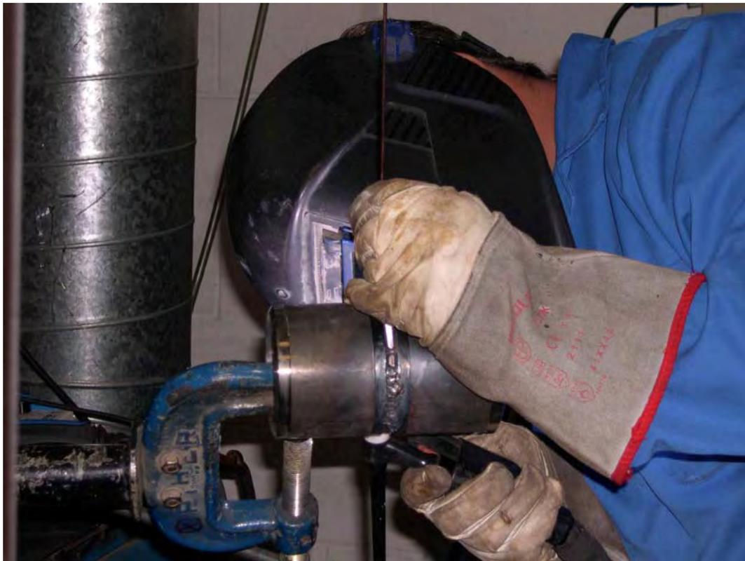
*Fotografía 3: Ensayo de soldadura manual*
