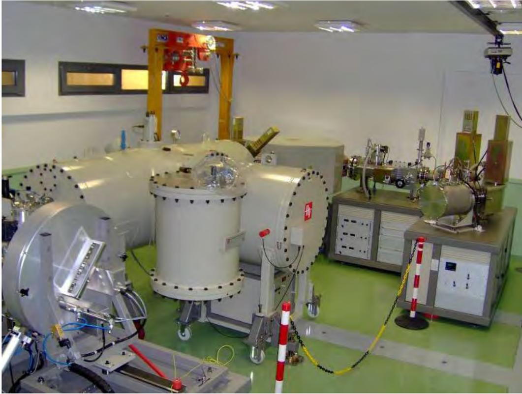
Figura 6.- El acelerador tandetron de 1MV para AMS
