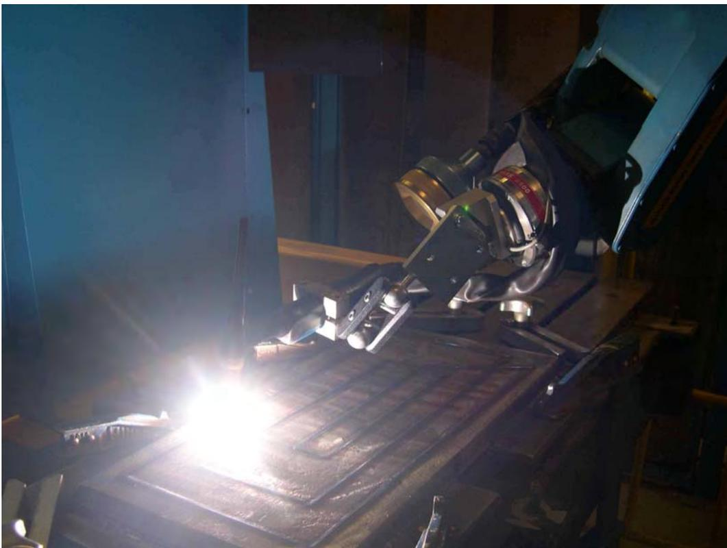
*Fotografía 2: Soldadura TIG con robot automático*
