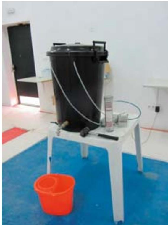
**Figura 4 Detalle del dispositivo empleado para el ejercicio de medida de gas radón en agua**
