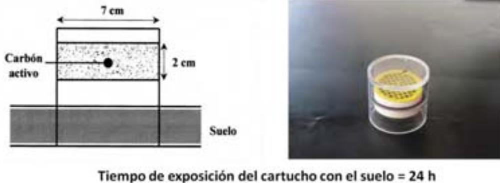
Figura 6: Exhalación en Rn del suelo por el método de adsorción sobre carbón activo
