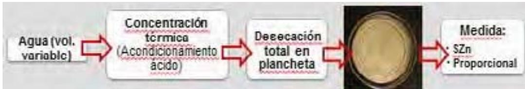
**Figura 2: Representación esquemática de las principales etapas del procedimiento de desecación.**
