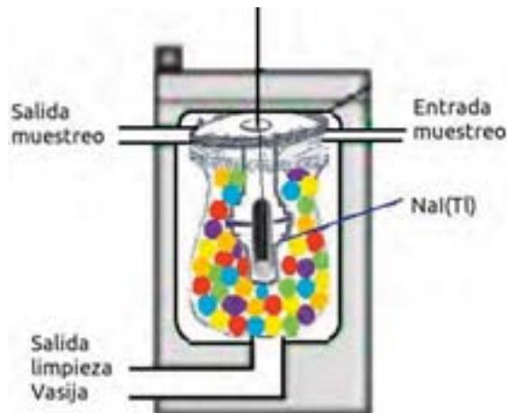
**Figura 5.- Esquema de la incorporación de la disolución patrón, mediante el uso de globos, en la vasija de la estación de aguas para obtener el calibrado en eficiencias experimental del nuevo sistema espectrométrico empleado.**
