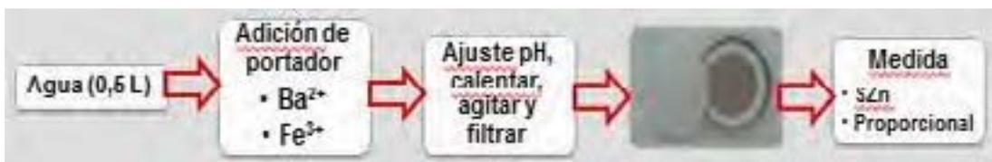
**Figura 3: Representación esquemática de las principales etapas del procedimiento de coprecipitación.**
