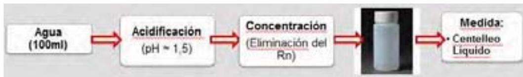
**Figura 5: Representación esquemática de las principales etapas del procedimiento de evaporación y de medida por centelleo líquido.**
