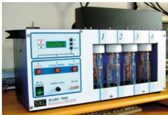
Figura 1. Imagen del colector de tritio atmosférico MARC 7000 (SDEC)
