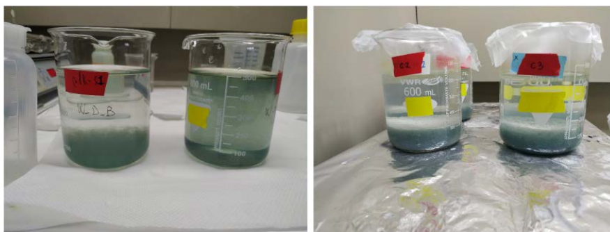
Figura 3: Proceso de co-precipitación con hierro sobre las muestras
