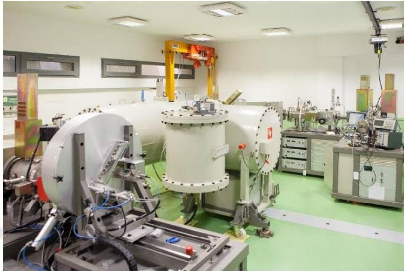
Imagen 2. SARA, el sistema de AMS de 1MV del Centro Nacional de Aceleradores.
