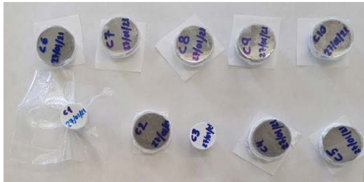
Figura 2: Muestras preparadas para las medidas por espectrometría gamma
