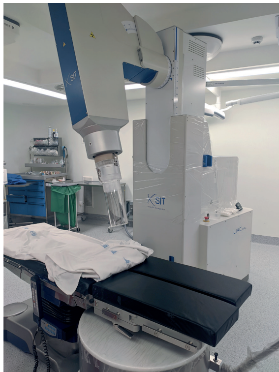
Figura 26. Aplicador para tratamiento de radioterapia intraoperatoria con electrones.
