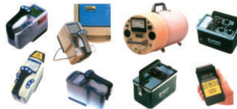
Distintos instrumentos medidores de radiación.
