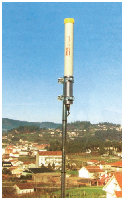
Sonda de medida de radiación gamma para medir la calidad radiológica del medio ambiente.
