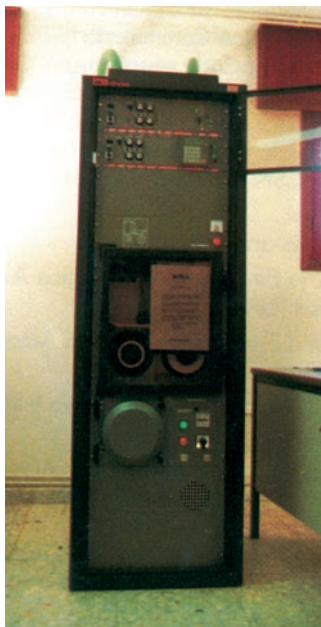
Interior de una estación radiológica automática de la red REVIRA
