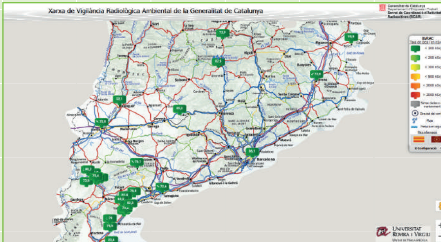
Figura 11. Visual de los valores de H^*(10) medidos en las estaciones de espectrometría gamma y en los detectores Geiger que conforman la XVRAC
