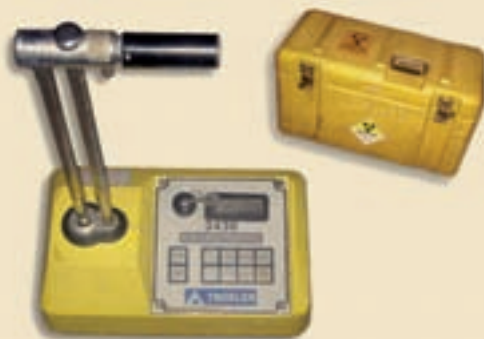
Medidor de densidad y humedad en suelos en superficie
