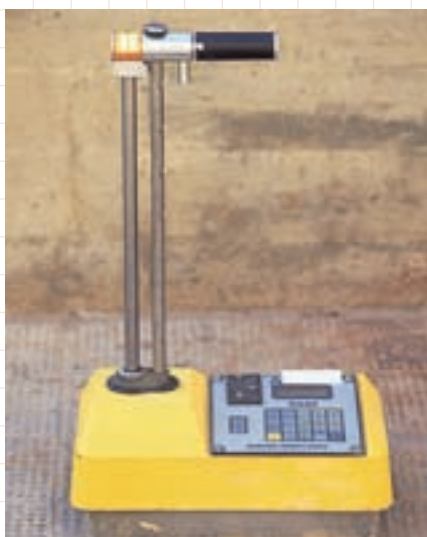
Medidor del grado de humedad
