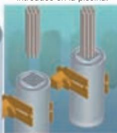
En el contenedor, que dispone de un bastidor con capacidad para 21 elementos, se van cargando los elementos (siempre bajo agua).
