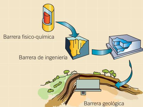
Funcionamiento y disposición de las barreras de seguridad
