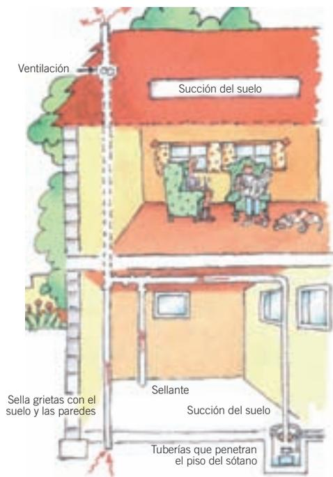
Esta ilustración presenta diferentes opciones de mitigación. El sistema de mitigación más común usualmente tiene sólo una tubería que penetra el piso del sótano, esta tubería también puede ser instalada en la parte exterior de la casa.
