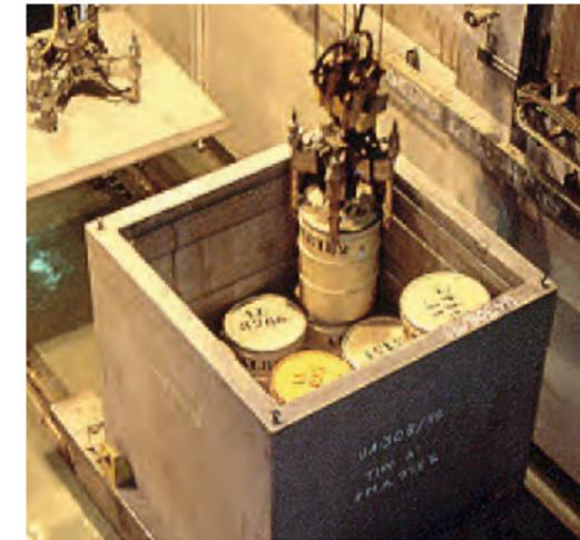
Figura 7. Bidones en los contenedores de hormigón antes de su sellado.
