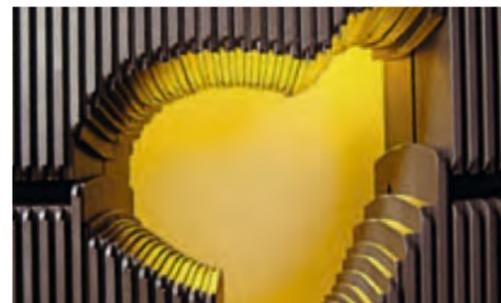
Figura 5. Colimador multiláminas. (cortesía de Varian)
