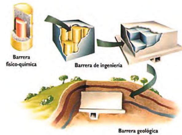
Figura 6. Esquema del sistema de barreras del almacenamiento.
