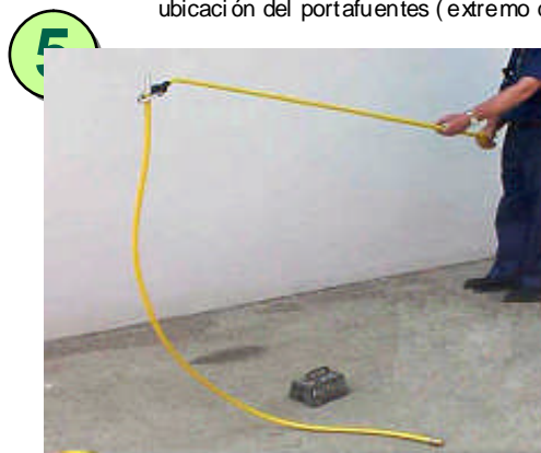
Con la ayuda de unas telepiñzas sacar el portafuentes de la manguera
