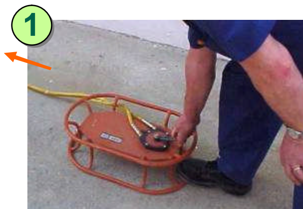
Empujar el portafuente hasta el puntal accionando el telemando
