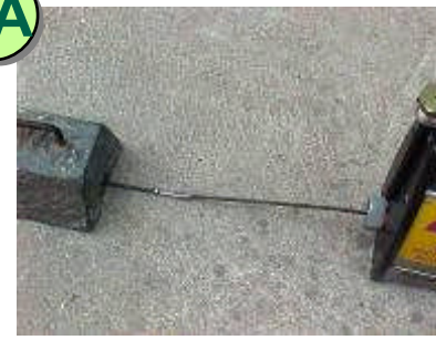
Accionar la manivela del telemando para que el portafuentes se introduzca en el contenedor
