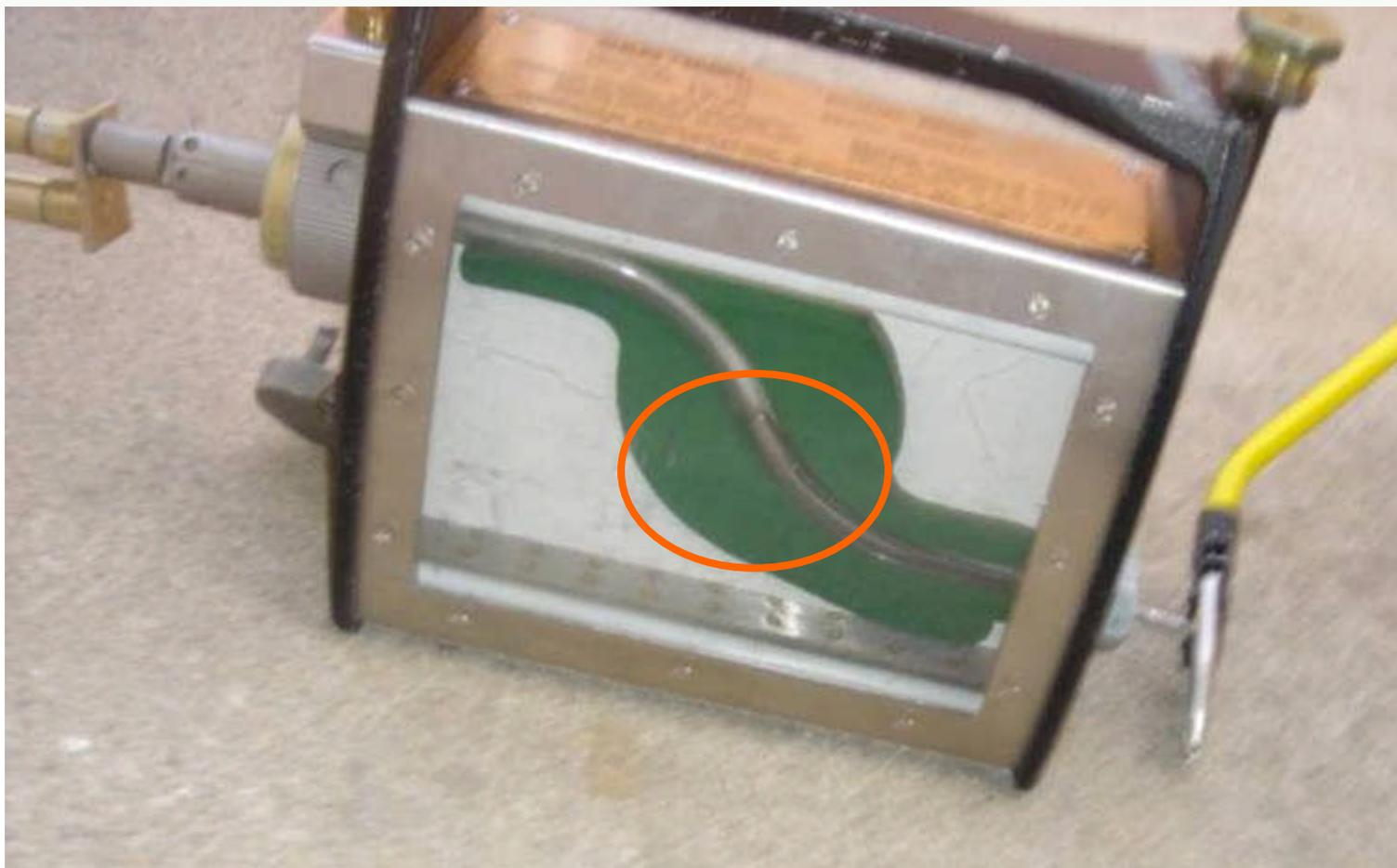
El portacápsulas quedará alojado en la zona de máximo blindaje del equipo si posicionamos la bola del conector del portafuentes al ras de la tuerca de conexión del tapón de salida.
