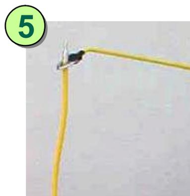
5 Sacar el portafuentes de la manguera e introducir el portafuentes al revés en el conducto del contenedor
