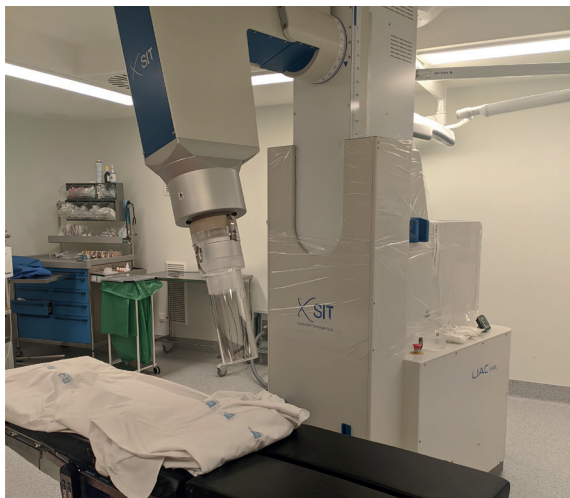
Figura 30. Aplicador para tratamiento de radioterapia intraoperatoria con electrones, producidos por un acelerador lineal móvil.
