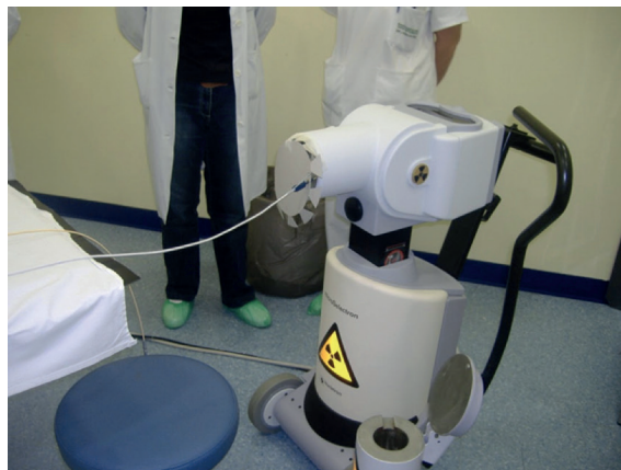
Figura 35. Proyector de fuentes radiactivas con un tubo de transferencia conectado.
